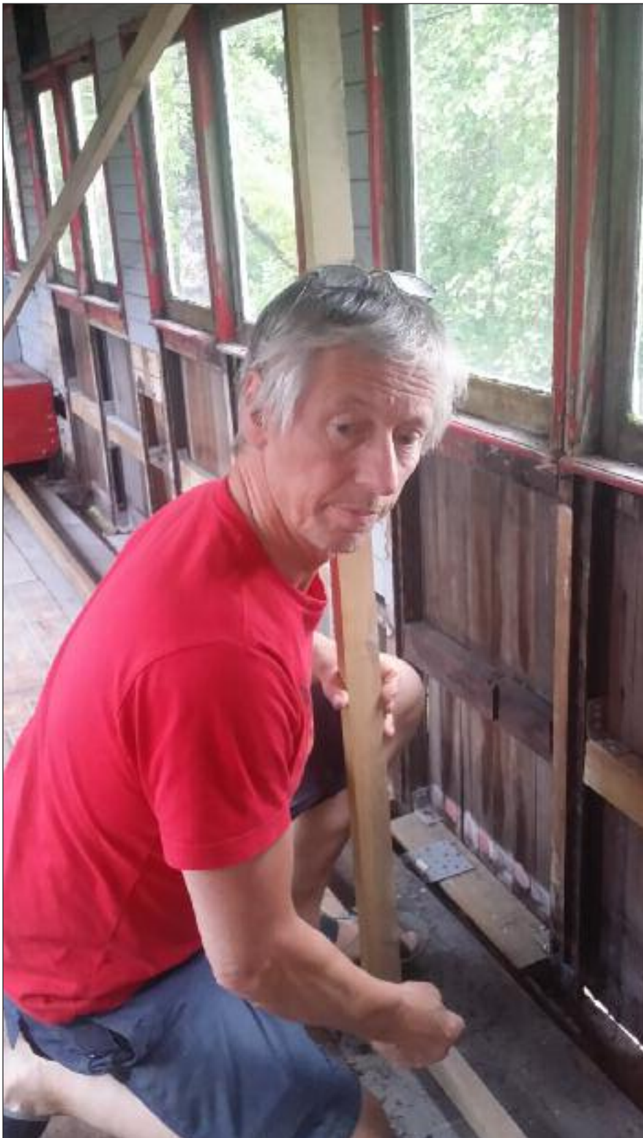
Jan Børsheim ga vogna et indre skjelett av tre, for å stive den av. Vi håpte det skulle gjøre at vogna overlevde flytting fra Kismul til Os.
