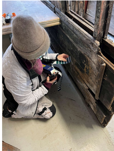
Fra fargeundersøkelsene. Fargetrapp lages på benk i CDFo I til venstre, på bildet til høyre undersøkes enn av sideveggene fra Lyssand-vognen.
