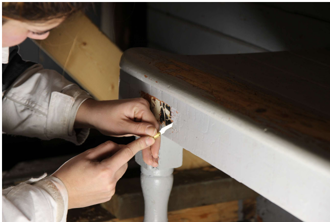
Fra fargeundersøkelsene. Fargetrapp lages på benk i CDFo I til venstre, på bildet til høyre undersøkes enn av sideveggene fra Lyssand-vognen.
