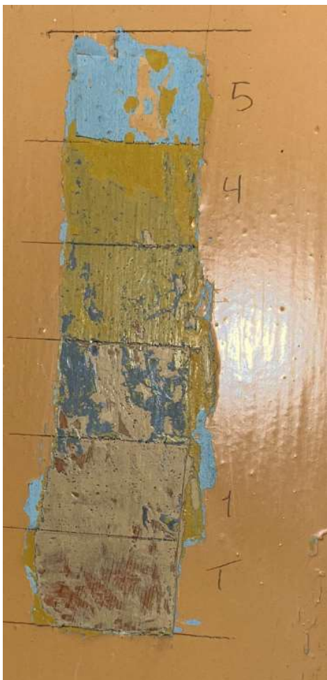
Figur 52. Fargetrapp på posthyllenes sidevegg ut mot kupeen. Det er andre steder på denne vegg funnet rester av hvit maling mellom lag 5 og dagens farge.
