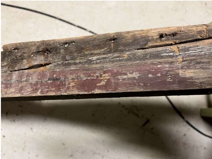
Figur 23. På utsiden av en bjelke fra Lyssand-vognen er det funnet rester av et malingslag som ligner mahogni og som er identifisert som NCS S7020-R. Ifølge malermester Nesttun er dette en nyere farge som ikke stammer fra Osbanens tid. Et annet sted på bjelken er det funnet gult og grønt som også må stamme fra perioden da vognkassen tjente som uthus.
