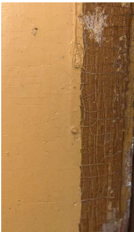
Figur 40. Eikelasur i Solstrand-vognen. Denne flaten til høyre i bildet ble stående tildekket av en sidevegg som ble bygget ny 1993, og ble derfor ikke malt av Osbanens Venner.
