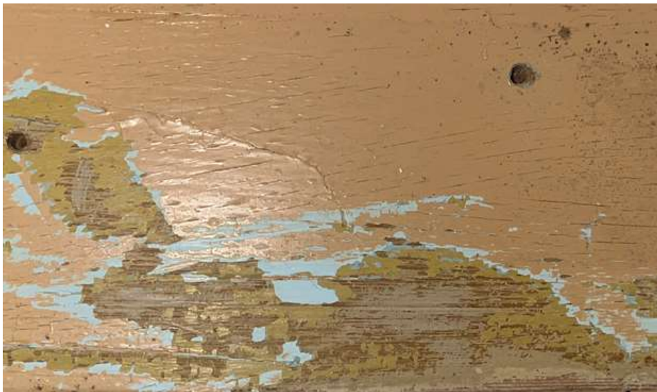
Figur 32. Del av det faste trestykket i skilleveggen på passasjersiden over døren. Eikelasur er her tydelig under det mørkegule laget.
