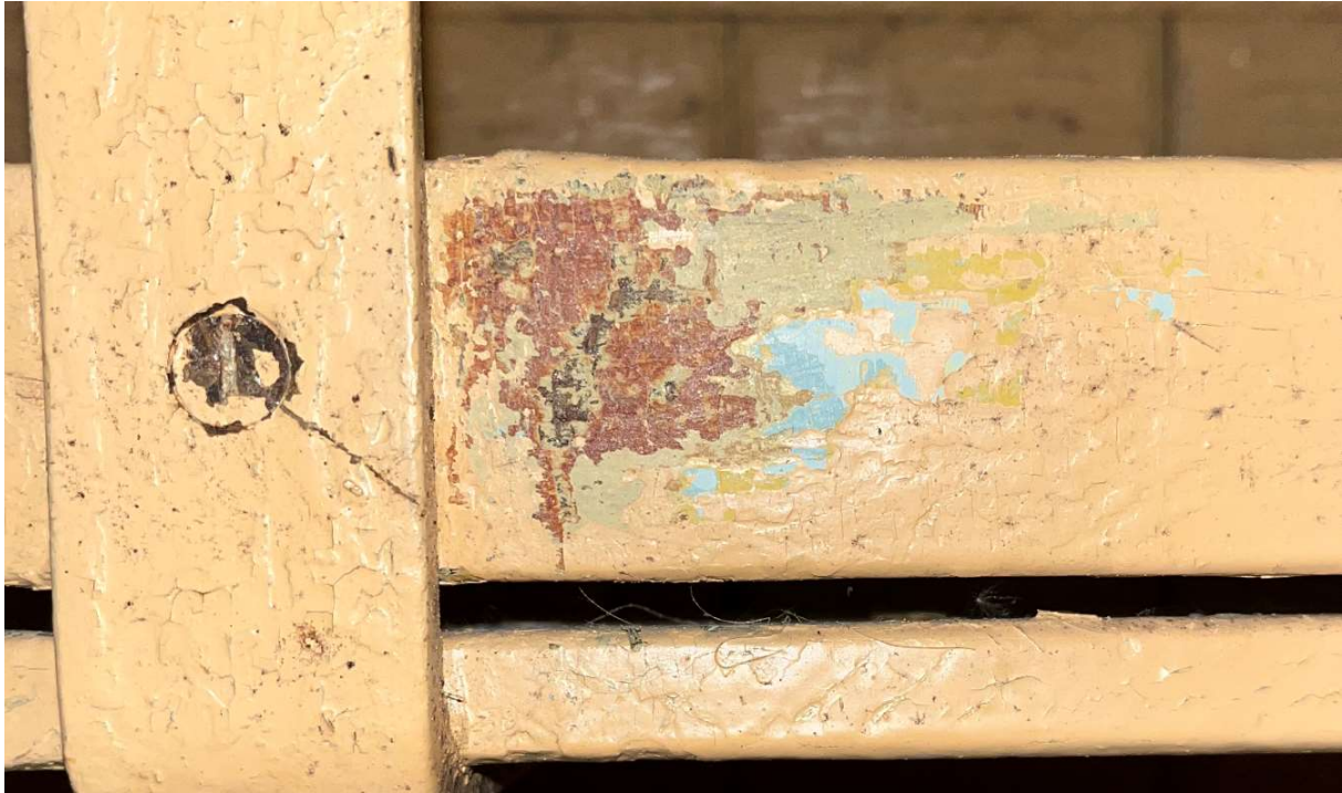
Figur 45. Enkle undersøkelser på bagasjehylle i CDFo I. Den rødbrune fargen trer her tydelig frem.
