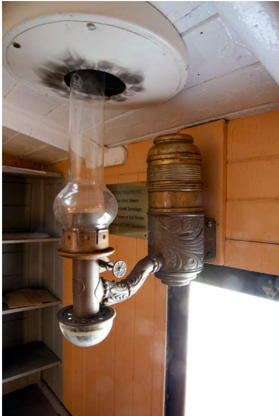
Figur 48. Original parafinlampe i postkupeen i CDFo I. Hetten over lampen er ikke original. Lampen ble innsatt i 1994 og stammer fra en av Osbanens Skabo-vogner. Foto: GS Foto.
