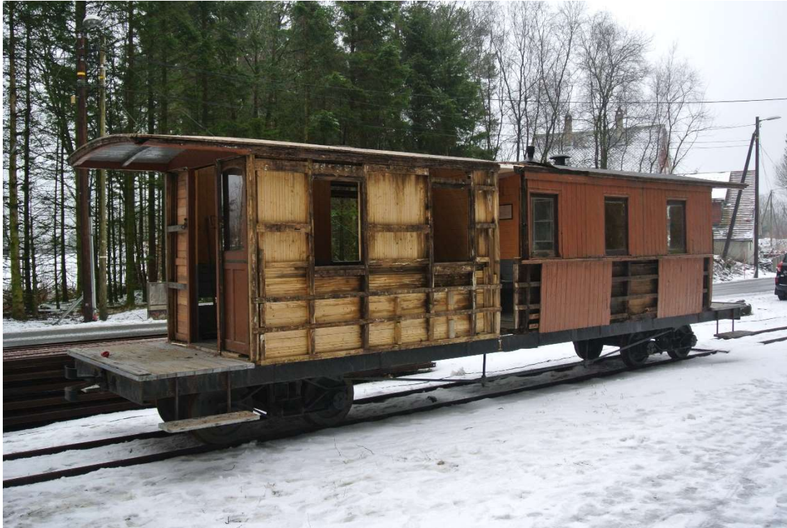
Figur 4. De to vognkassene som står på Stend, fotografert etter demontering i 2015. Nærmest står Solstrand-vognen. Her er alt av sideveggene uoriginalt, men er foreløpig beholdt for å holde resten, dvs. gulv, endevegg og tak, sammen. Foto: Per Ivar Tautra.
