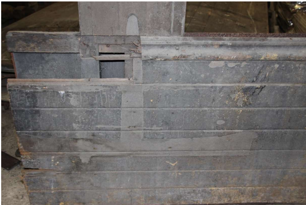
Figur 42. Det tydeligste av de to avtrykkene etter benker med rygg som finnes på veggene fra Lyssand-vognen danner et godt grunnlag for å kunne rekonstruere en slik benk. Foto: Per Ivar Tautra.
