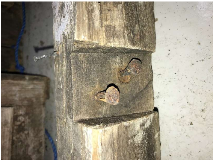
Figur 18. Stokk i sidevegg der takbjelken har vært festet. Del fra Lyssand-vognen.
