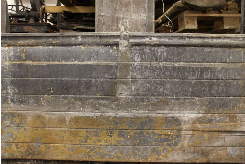
Figur 44. Avtegning av benk på veggen i Lyssand-vognen. Vi ser tydelig en fot i hjørnet til høyre.
