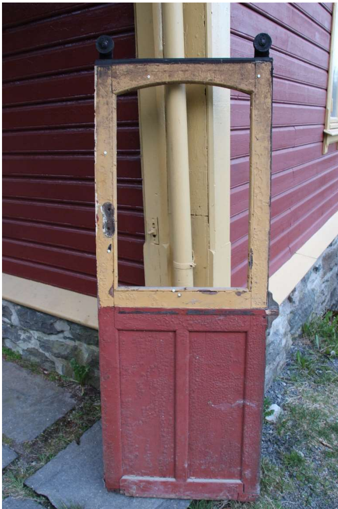
Figur 26. Den opprinnelige skyvedøren fra vogn CDFo I. Oldburys skyvedører er karakterisert ved at åpningen for vindusglasset er buet i toppen, i motsetning til Skabos skyvedører, som hadde rektangulære vinduer. Foto: Per Ivar Tautra.
