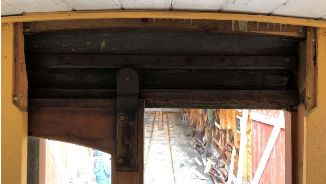
Figur 27. Skinner for skyvedør i endeveggen i Solstrand-vognen. Foto: Helge Berntsen.
