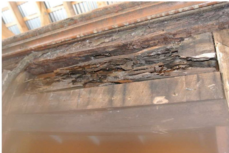
Figur 10. Råte er dessverre fremtredende på store deler av vognkassen fra CDFo I. Foto: Per Ivar Tautra.
