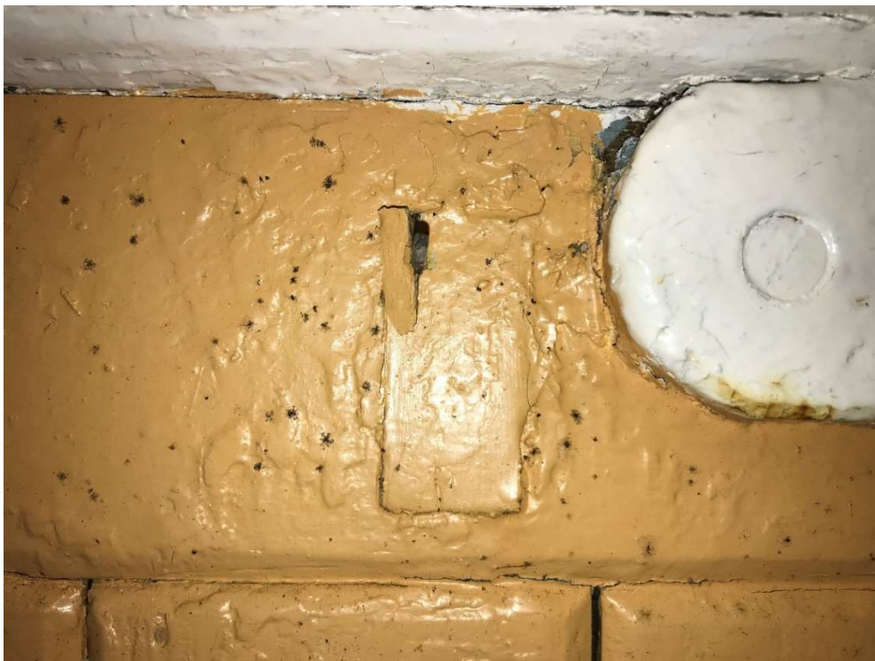
Figur 37. Avkappet tapp i sideveggen der hvor skilleveggen mellom postkupeen og passasjeravdelingen stod i perioden 1919-1929. Foto: Per Ivar Tautra.
