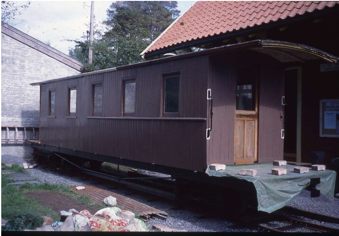
Figur 3. Den nesten ferdig istandsatte vognen i 1994, bestående av kassen fra CDFo I nærmest, et kort nybygget parti og Solstrand-vognen bakerst. Foto: Per Ivar Tautra.
