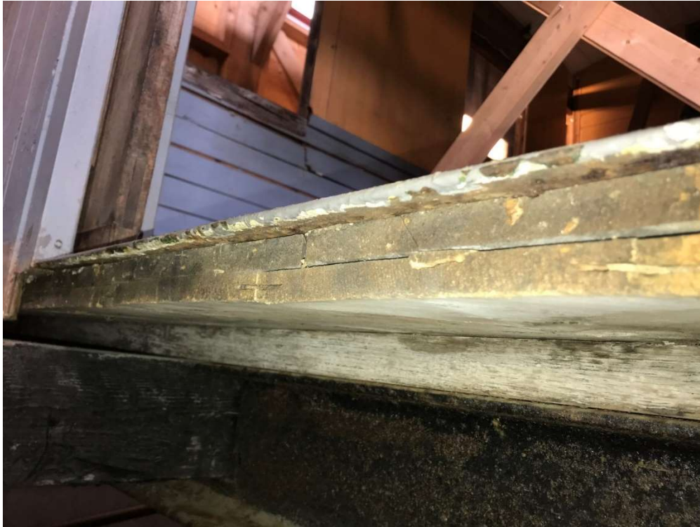
Figur 21. To lag med gulvbord i Solstrand-vognen, foto tatt der gulvet er saget over da vognkassen ble delt for salg i 1935/36. Foto: Per Ivar Tautra.
