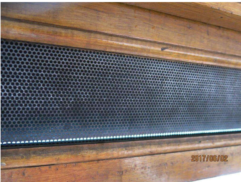
Figur 59. Netting over vinduer sett fra innsiden i en passasjervogn ved Welsh Highland Railway i 2017. Foto: Carl Frederik Thorsager.
