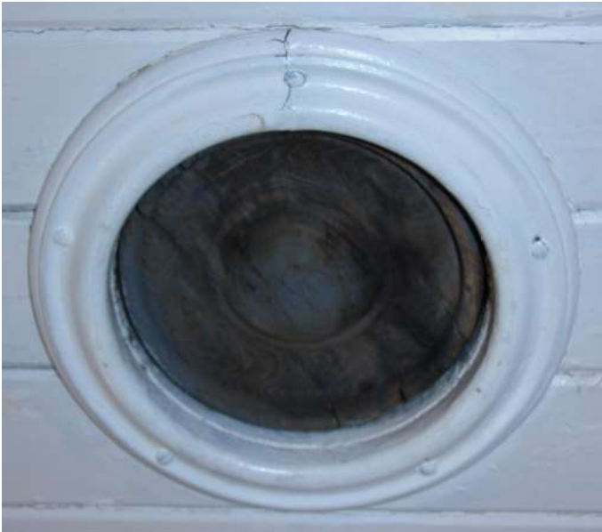
Figur 46. Trekloss med tilskåret profil som fyller lampehullet i taket i Solstrand-vognen, her sett fra undersiden.
