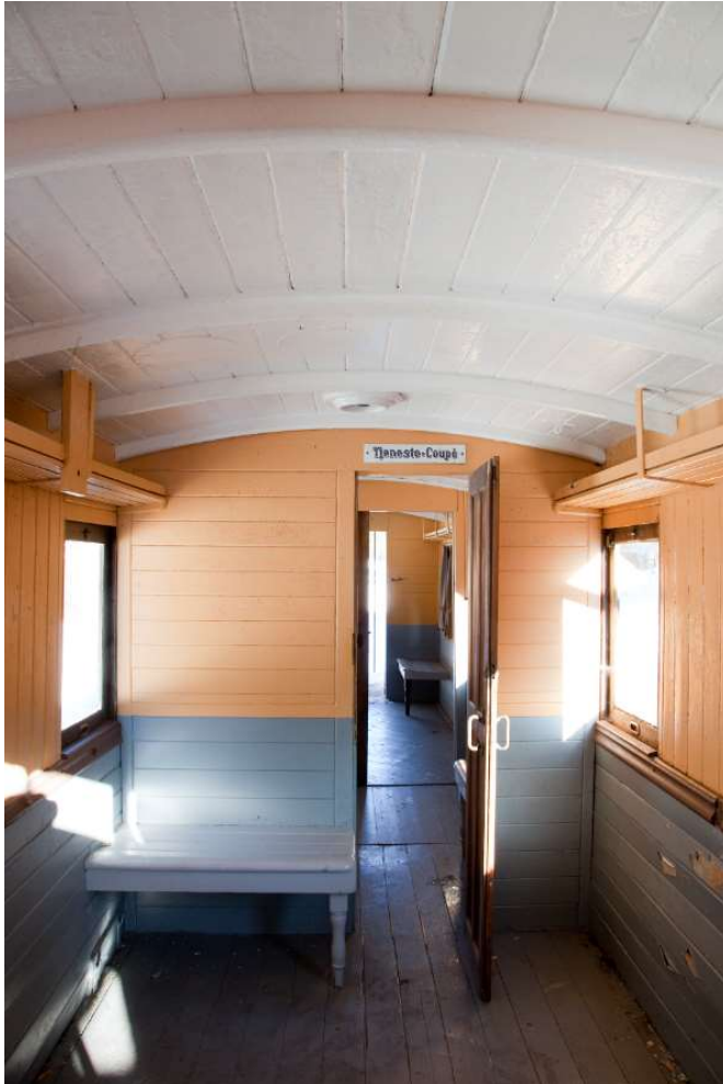
Figur 17. Interiøret i passasjeravdelingen i vogn CDFo I i 2010. Legg merke til bjelkene og buene (takåsene) i taket. Foto: GS Foto.
