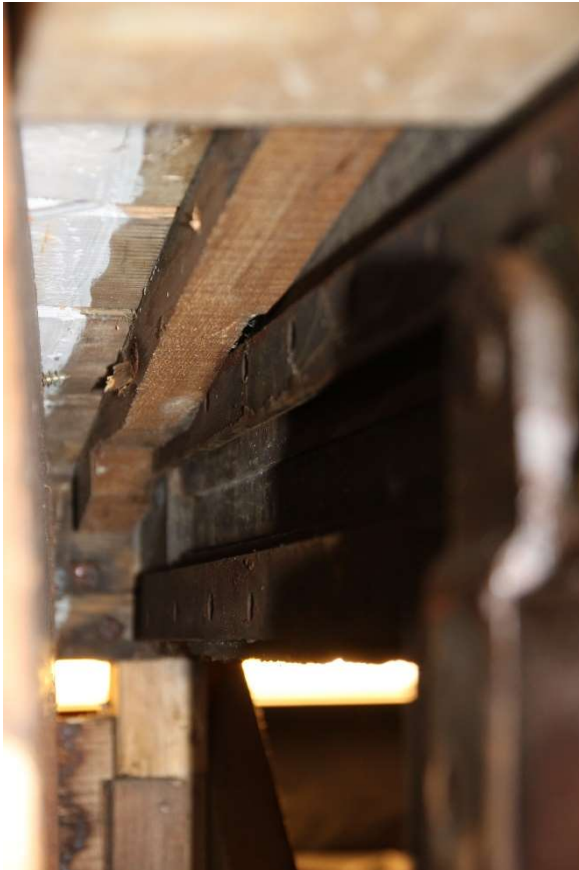
Figur 28. Foto som viser hvordan skinnene avsluttes mot taket i vognkassens venstre side, dvs. der hvor døren går inn i veggen. Foto: Per Ivar Tautra.
