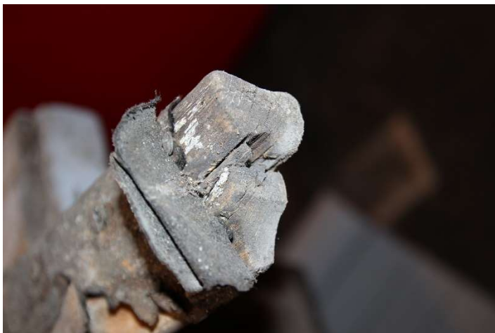
Figur 16. Enden av del av original takrenne fra Solstrand-vognen. Foto: Per Ivar Tautra.
