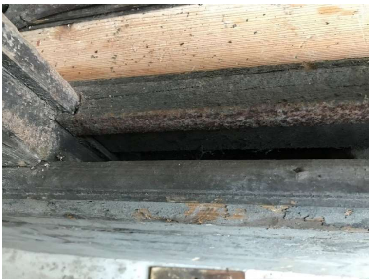
Figur 23. Jernlist montert fast i yttervegg i vindusåpning i Lyssand-vognen. Foto: Per Ivar Tautra.
