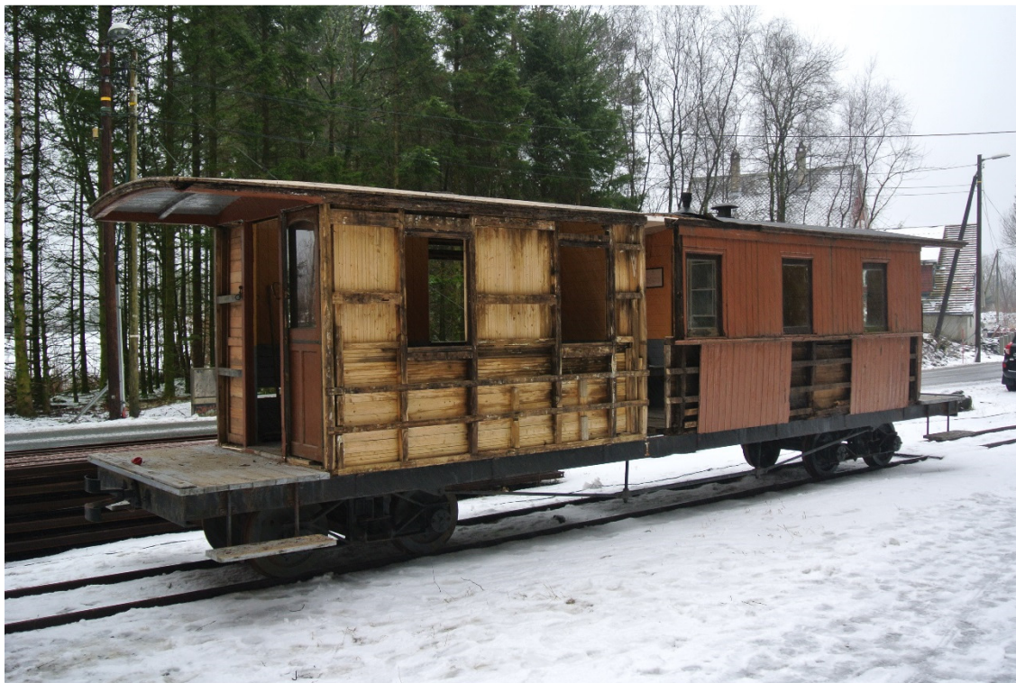
De to vognkassene som står på Stend. Nærmest står «Solstrand-vognen». Her er alt av sideveggene uoriginalt, men er foreløpig beholdt for å holde resten, dvs. gulv, endevegg og tak, sammen. Foto: Per Ivar Tautra.
