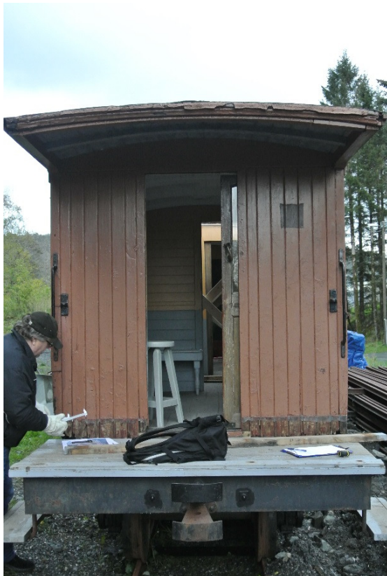
CDFo I sett fra enden. Merk innsvinget nederst. Foto: Tautra.
