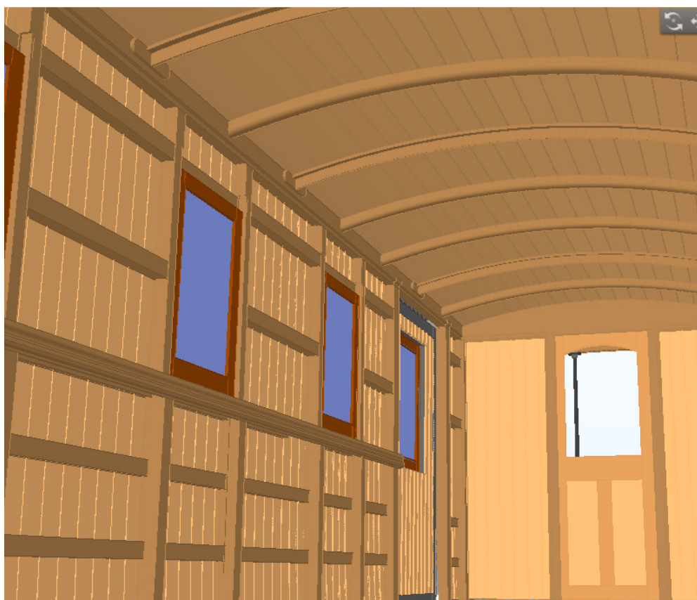
Utsnitt fra modellen. Vi ser vognen innenfra. Innvendig bordkledning er ikke modellert ennå. Alle bord, stenderverk, lister, takbuer og bord m.v. er tilstrebet modellert med millimeters nøyaktighet.
